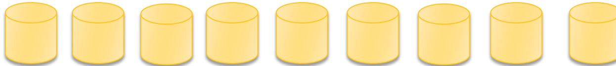
Il **RAID 5** ha **1** solo disco in più ma parità e dati sono **distribuiti ciclicamente** su tutti: un blocco di dati viene memorizzato sui dischi da **1 a 8** e la parità sul **9**, un secondo blocco dati viene memorizzato sui dischi da **9 a 7** e la parità sul **8** ....
